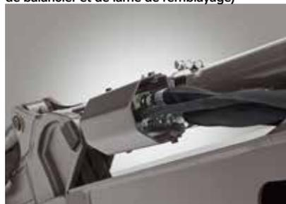
Circuit hydraulique auxiliaire secondaire
